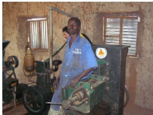
Landelijke Jatropa-olieproductie in Mali: de verbrandingsmotor kan zowel een oliepers aandrijven bij het persen van de jatrophazaden als een elektrogeengroep om een lokale dorpsgemeenschap van elektriciteit te voorzien (Mali).
